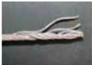
EFFILOCHAGE Câble visiblement distendu ou déroulé
